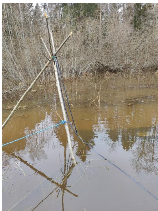
Bild 5. För ryssjan i den mellersta bäcken byggdes en specialkonstruktion, så att den kunde höjas och sänkas när den vittjades.
