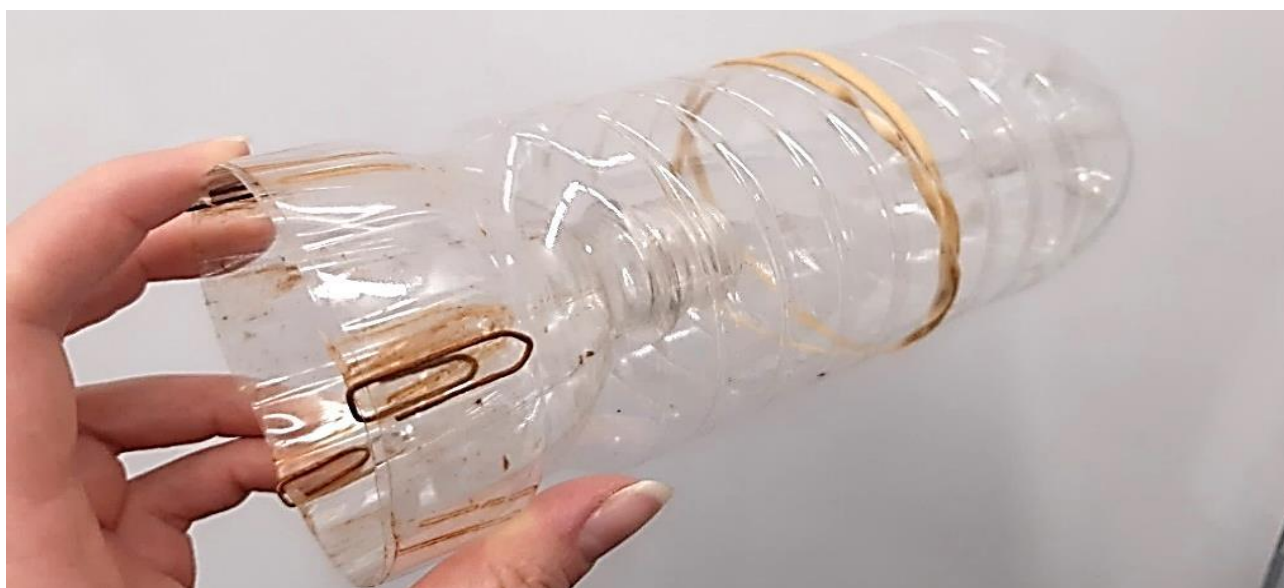
Figur 6. Aktiv fälla (flaskfångst) som användes vid fångst av ryggradslösa djur som lever i öppet vatten. Foto: KVVY Tutkimus Oy.
