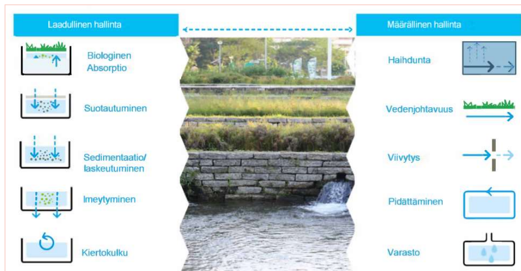
Kuva 14. Hulevesien laadullisen ja määrällisen hallinnan menetelmät
