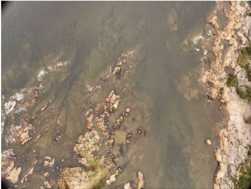
Figur 1. Drönarbild av vikens mynning där undervattensklipporna som potentiellt begränsar flödet syns tydligt. Djupet mellan klipporna är ändå 3 m och bredden av kanalen mellan klipporna är ca en tredjedel av totala bredden.
